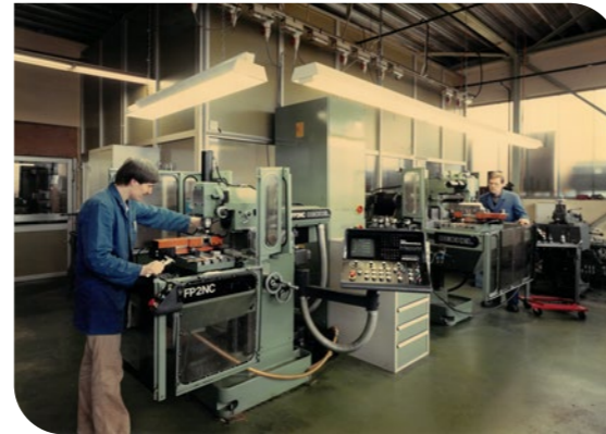
1987 – Wolfgang Schüler bei der Bedienung einer der beiden CNC-gesteuerten Fräsmaschinen
